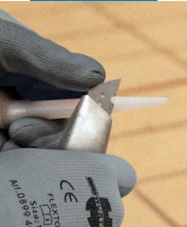
Rezanje mlaznice prema veličini fuge
